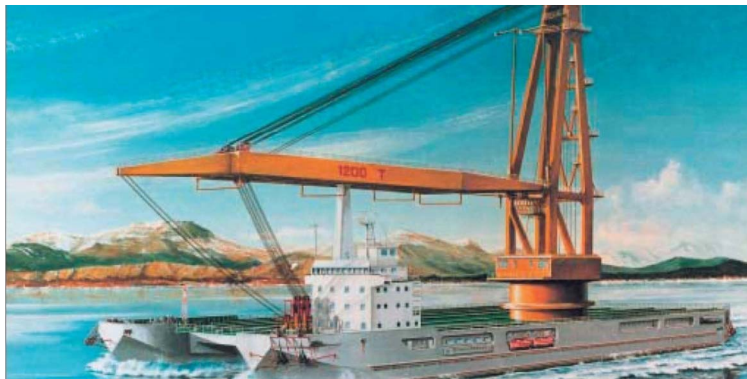
Katamaranska dizalica , Nosivost: 1200 t, izgrađena za Sudoimport 1989. godine u brodogradilištu “3. maj”, za offshore operacije na Kaspiju. (Projekt: “3.maj”; valno opterećenje: DnV, Oslo; analiza čvrstoće: FSB Zagreb; modelska ispitivanja: MARINTEK, Trondheim, Norveška)
