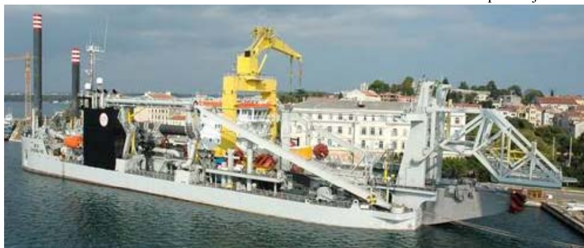
Katamaranska dizalica , Nosivost: 1200 t, izgrađena za Sudoimport 1989. godine u brodogradilištu “3. maj”, za offshore operacije na Kaspiju. (Projekt: “3.maj”; valno opterećenje: DnV, Oslo; analiza čvrstoće: FSB Zagreb; modelska ispitivanja: MARINTEK, Trondheim, Norveška)
